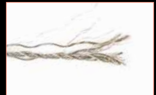
SKARP KANT SVIKT: Tradisjonell kabellivline med energidemper
